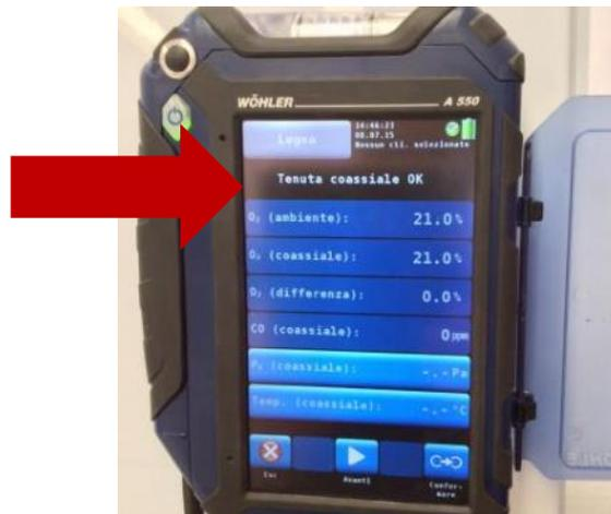
Programma speciale dell'analizzatore combustione con esito Tenuta coassiale OK o NON OK
