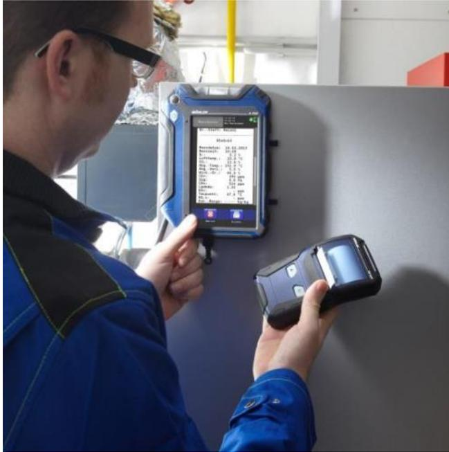
Analisi di combustione con valore medio di 900 misure (15 minuti)
