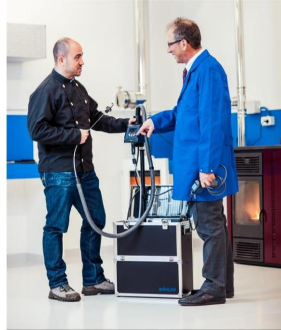
Analisi polveri metodo gravimetrico automatico di 15 minuti.
