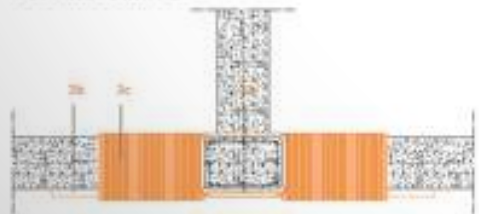
PROSPETTO, RINFORZO DEL NODO TRAVE PILASTRO CON FRP
