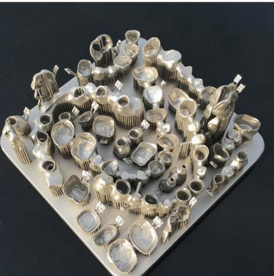
PIATTAFORMA DI SINTERIZZAZIONE
