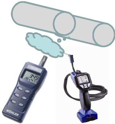
Per gli apparecchi a tiraggio forzato si dovrà controllare l'assenza di riflusso dei fumi in ambiente mediante la misurazione del monossido di carbonio CO mediante l'analizzatore di combustione multifunzione e l'anidride carbonica mediante speciale analizzatore in grado di leggere la variazione della CO<sub>2</sub> anche con pochi ppm.
