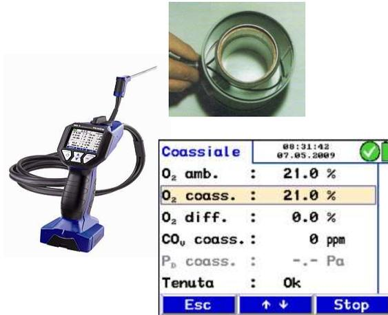
Per la verifica assenza di perdite si esegue una prova di tenuta dello scarico coassiale con l'apposita funzione dell'analizzatore di combustione multifunzione, eventualmente in combinazione con la sonda multiforo
