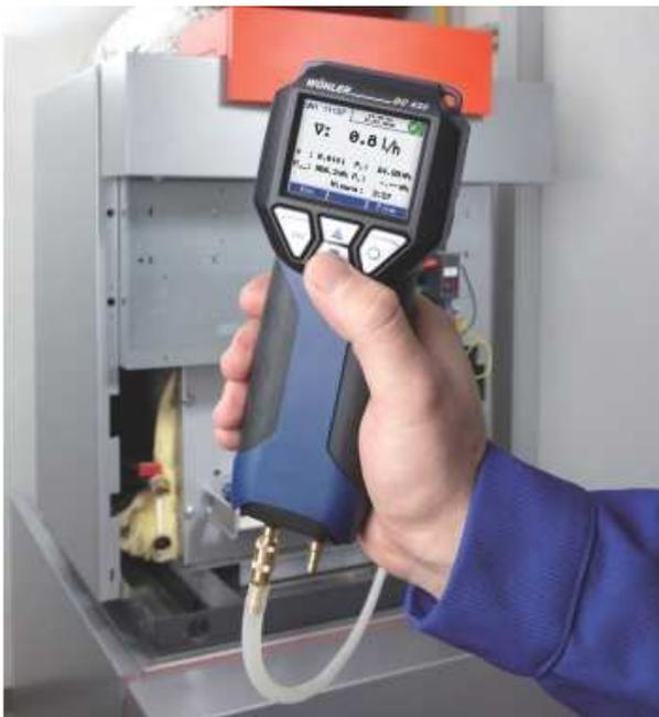
Per la prova di tenuta delle tubazioni del gas è possibile eseguire anche una prova di tenuta con il metodo diretto semplicemente chiudendo la valvola del gas e collegando l'apposito strumento alla presa della valvola della caldaia e dopo alcuni minuti si legge la perdita dell'impianto gas.
